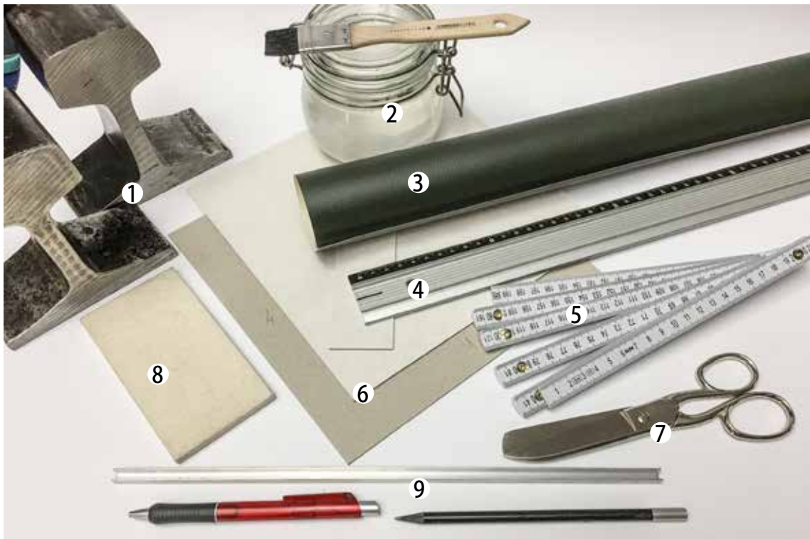
1 Gewichte, 2 Leim, 3 Überzugsmaterial, 4 Lineal, 5 Zollstab, 6 einseitig aufkaschierter Graukarton, 7 Schere, 8 Filzraker, 9 Alu-Distanzschiene
